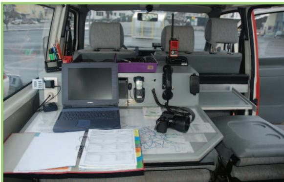
Die Arbeit der Einsatzleitung wird durch einen entfernbaren Tisch erleichtert, der alle nötigen Utensilien beherbergt.
