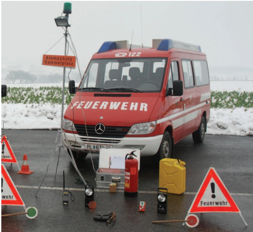
abgestimmt während im Mannschaftstransportfahrzeug Ausrüstung für den Aufbau und Betrieb eines Atemschutzsammelplatzes, und macht deutlich dass auch "kleine" Fahrzeuge "große" Aufgaben erwartet.
